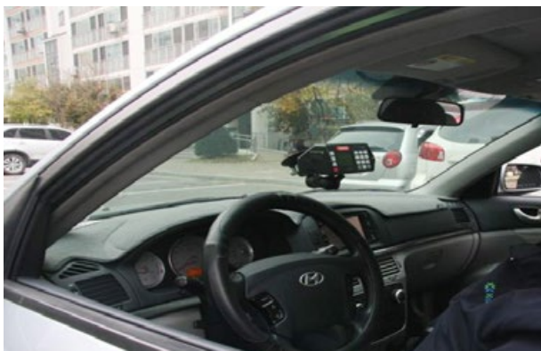
[그림 4] 가속측정장비(Vericom 4000) 설치 장면
